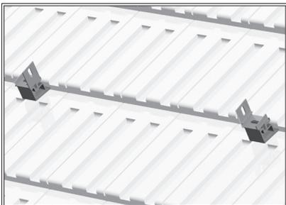
Na već montirane osnovne ploče - nosač 1 (art. 50 206) i nosećeg profila - nosač 2 (art. 50 207), postavljamo ugaone profile (art. 50 203) pomoću samo - osigurujućeg vijka M10 x 20 (art. 50 210), zarotirani za 90 stepeni.
