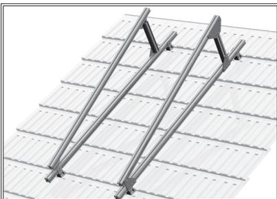
Postizanje željenog ugla je omogućeno pomoću promenljive ugaone ploče (art. 50 204). Univerzalni profili, pomoću samo - osigurujućeg vijka M10 x 20 (art. 50 210) i vijak kanali postavljaju se na ugaone ploče (art. 50 205) i (art. 50 204).
