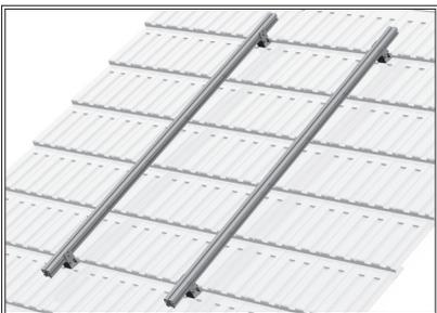
Univerzalni profili (art. 50 100), pomoću samo - osigurujućeg vijka M10 x 20 (art. 50 210) i vijak kanali postavljaju se na ugaonog profila (art. 50 203), paralelno sa krovnim gredama.
