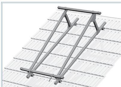
Na ugaone profile (art. 50 203), koji su zarotirani za 90 stepeni, univerzalni profili (art. 50 100) postavljaju se normalno sa krovnim gredama. Na već montiranu, univerzalnu platformu, na donjem profilu postavljaju se inox-držače (art. 50 215), za sprečavanje klizanje kolektora tokom montaže.
