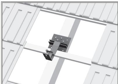
Pomoću samo - osigurujućeg vijka M10 x 20 (art. 50 210), ugaoni profil se povezuje sa nosećeg profila - nosač 2 (art. 50 207). Ugaoni profil (art. 50 203), je važan element u montažu univerzalnog sistema. Koristi se u cross-montažu, to je spojni element između univerzalnog profila (art. 50 100) i krovne kuke - nosač 2 (art. 50 207).
