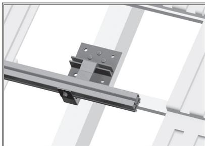
Univerzalni profil (art. 50 100), postavlja se na ugaonog profila (art. 50 203). Pričvršćivanje se izvodi pomoću samo - osigurujućeg vijka M10 x 20 (art. 50 210) i vijak kanali. Vijak kanali su dizajnirani tako da se vijak može zategnuti s obrtnim momentom od 17 Nm.
