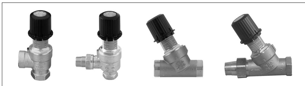
AVDO je regulator protoka bez pomoćne energije koji se prvenstveno koristi za održavanje minimalnog protoka (kroz npr. gasni kotao malog kapaciteta), kao i za kontrolu diferencijalnog pritiska u sistemu centralnog grejanja.
