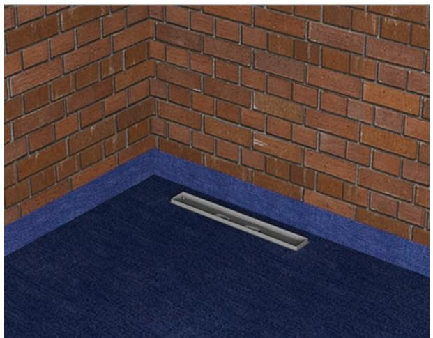
**PT** Aplicar a impermeabilização no pavimento e paredes
