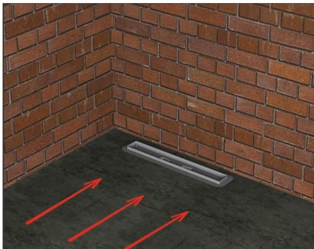
**PT** Aplicar uma inclinação de 1% a 2% na direção da calha de duche
