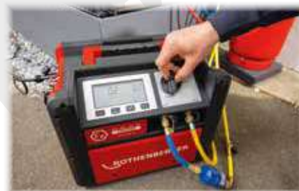
Funkcija samočišćenja za potpuno pražnjenje rekuperatora
